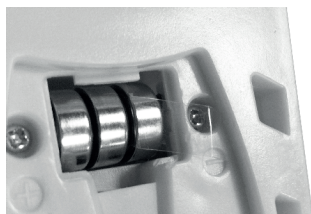
Fig. 5 – Troca das baterias (3 baterias, 1,5 V)
