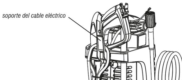
Figura 6 – Montaje del soporte del cable eléctrico
