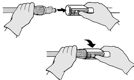
Figura 2 – Conectando a extensão na lança
