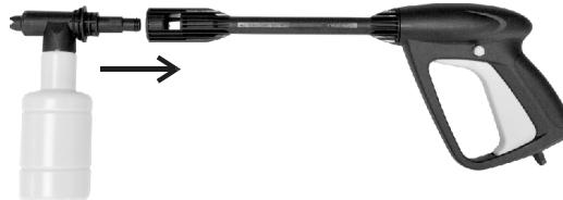
Figura 7 – Conexão do acessório para detergente
