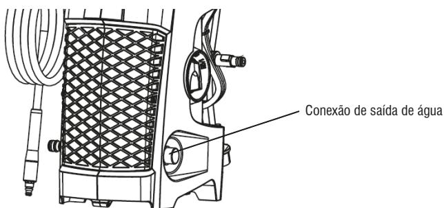
Figura 4 – Conexão de saída de água
