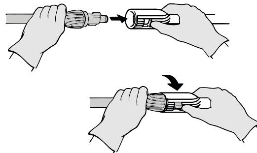
Figura 2 – Conectando la extensión en la lanza
