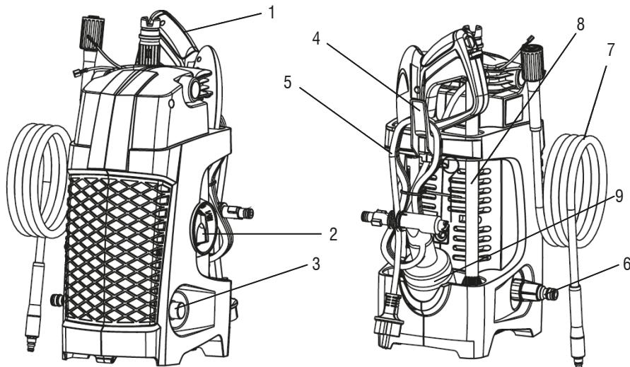
Figura 1 – Componentes da lavadora de alta pressão
