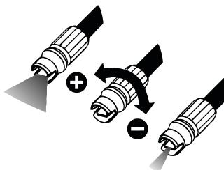
Figura 10 – Ajuste del abanico del chorro
