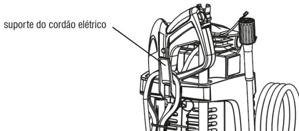
Figura 6 – Montagem do suporte do cordão elétrico
