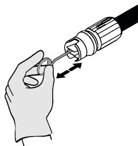
Figura 12 – Limpeza do bico da lança
