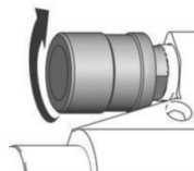
Figura 9 – Regulando la presión
