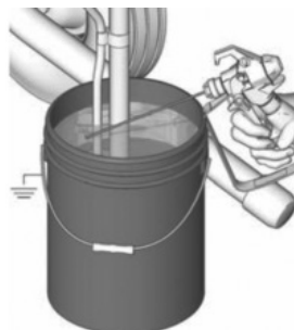
Figura 12 - Acionando a máquina para liberar pressão
