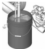
Figura 12 – Accionando la máquina para liberar presión
