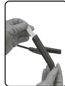
Fig. 20 – Filtro de plástico del mango
