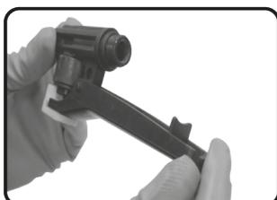
Fig. 23 – Inspección del gatillo
