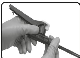
Fig. 22 – Retirando la lanza del gatillo
