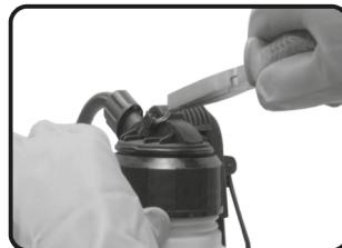
Fig. 6 – Retirando o pino trava da alavanca do pistão
