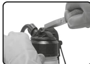
Fig. 6 – Retirando el perno de trabado de la palanca del pistón
