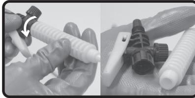
10. Desmontar la conexión del pico, girándola en sentido antihorario, de acuerdo a la fig. 18 y verificar la posibilidad de obstrucciones.
