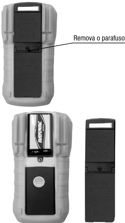
Fig. 3 – Substituição da bateria
