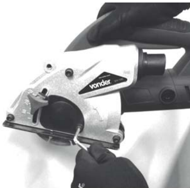
Figura 2 – Retirar a tampa do eixo (5)
