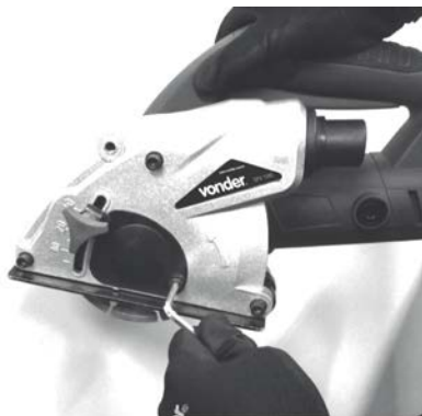
Figura 2 – Retire la tapa del eje (5)
