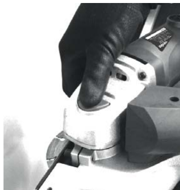
Figura 3 – Accione el botón trava del eje
