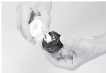
Fig. 5 – Aplicar fita veda rosca
