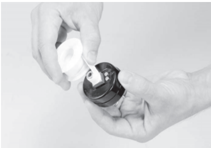
Fig. 5 – Aplicar cinta téflon
