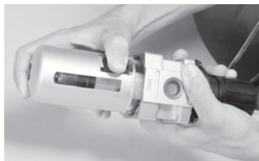
Fig. 3 – Recolocar a proteção do copo
