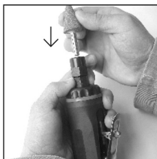
Figura 3 – Instalando una punta montada.
