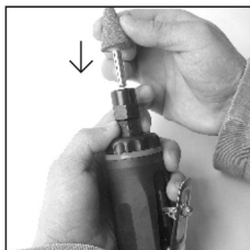
Figura 3 – Instalando uma ponta montada
