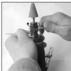
Figura 4 – Apretando la punta montada
