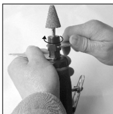
Figura 4 – Apertando a ponta montada
