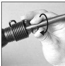
Fig. 3 – Fixação do cinzel na mola/retentor
