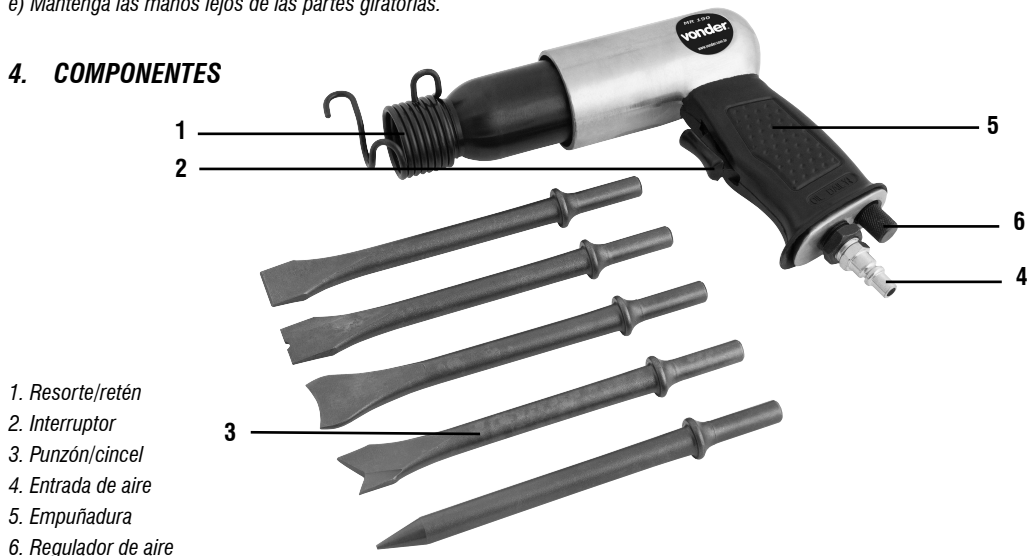
Fig. 1 – Componentes de la herramienta
