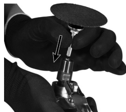
Fig. 3 – Instalando um acessório
