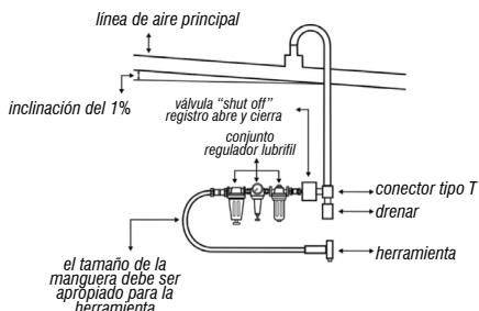
Fig. 2 – Proyecto de red de aire comprimido
