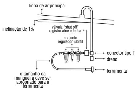
Fig. 2 – Projeto de rede de ar comprimido
