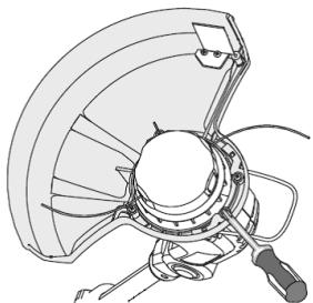
Fig. 5 – Protección de seguridad de la bordeadora
