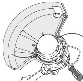
Fig. 5 – Instalação da proteção de segurança
