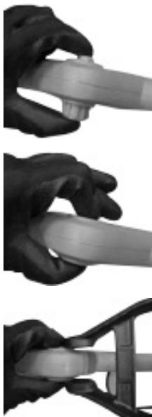
Fig. 2 – Instalação do punho inferior
