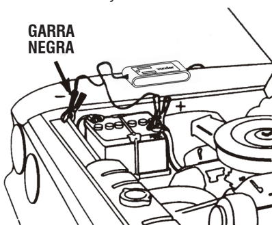
Fig. 4 – Cargando la batería de un vehículo
