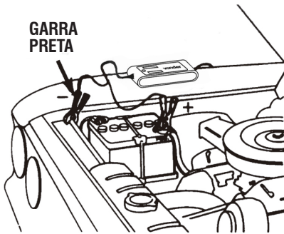
Fig. 4 – Carregando a bateria de um veículo
