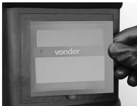
Fig. 3 – Inserte el nuevo lente externo
