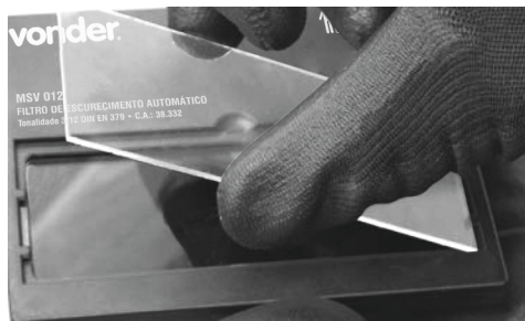
Fig. 4 – Insira a nova lente interna
