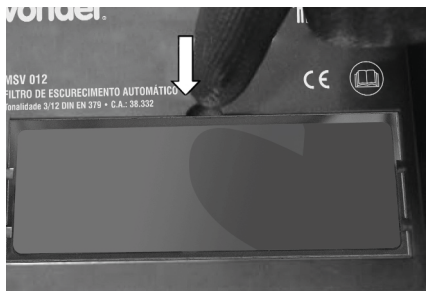
Fig. 3 – Retire a lente interna danificada
