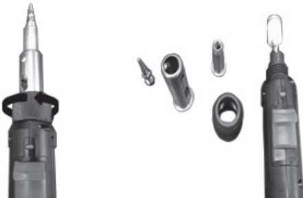
Fig. 6 – Desmontando el conjunto de soldadura
