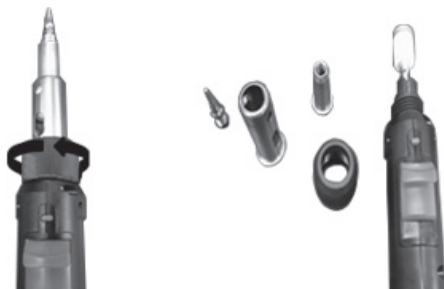
Fig. 6 – Desmontando o conjunto de solda
