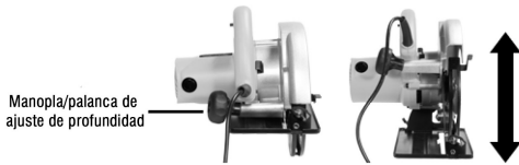
Fig. 4 – Ajuste de profundidad de corte
