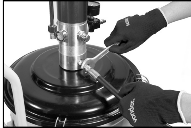
Figura 5 – Fixação da mangueira na bomba
