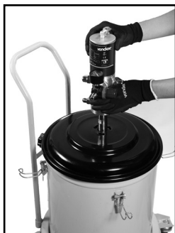
Figura 4 – Montagem da bomba de sucção na tampa e fixação da tampa no balde
