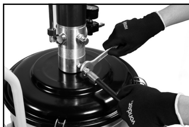
Figura 5 – Fijación de la manguera en la bomba
