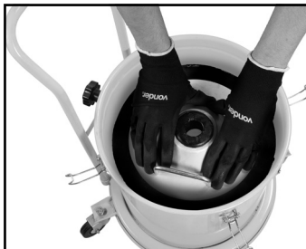
Figura 3 – Empuje la placa compactadora
