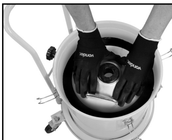
Figura 3 – Empurre a placa compactadora
