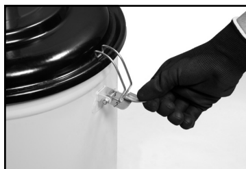
Figura 4 – Montaje de la bomba de succión en la tapa del balde y fijación de la tapa en el balde
