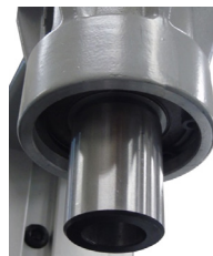
Fig. 2 – Encaje para broca cónico sin el uso de un adaptador
