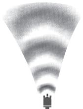
Pulverização sai de forma turbulenta ou falhada | Pouco material na caneca               | Adicione mais material na caneca                                             |
