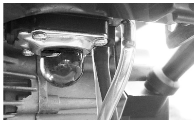
Fig. 5 – Bomba de combustible
