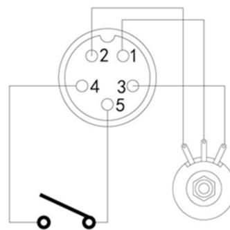
Figura 4 – Esquema de conexión del pedal
