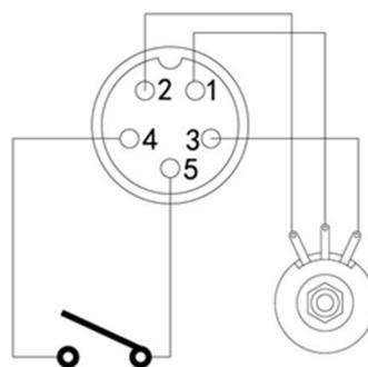
Figura 4 – Esquema de ligação do pedal
