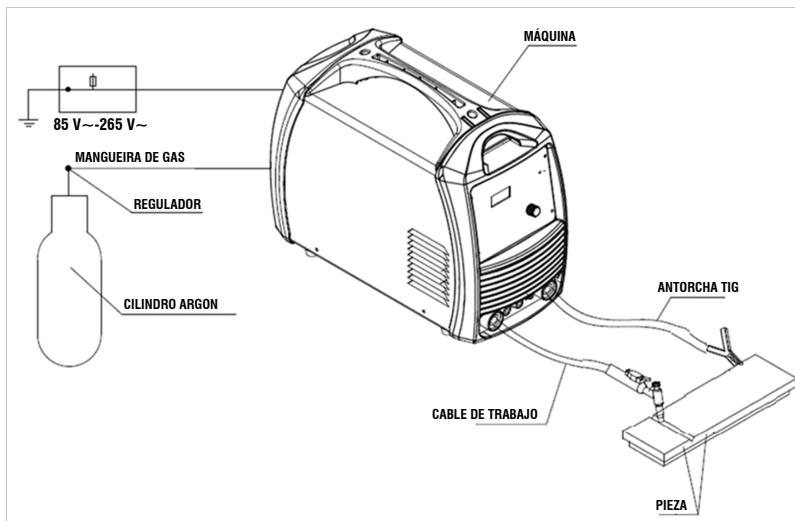
Figura 3 – Montaje del conjunto de soldadura TIG
