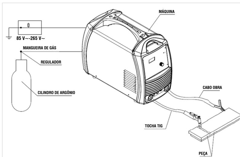
Figura 3 – Montagem do conjunto para soldagem TIG
