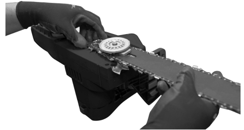
Fig. 5 – Montaje del sable y cadena de corte
