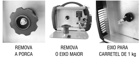
Fig. 7 – Eixo do carretel para rolo de arame de 1 kg
