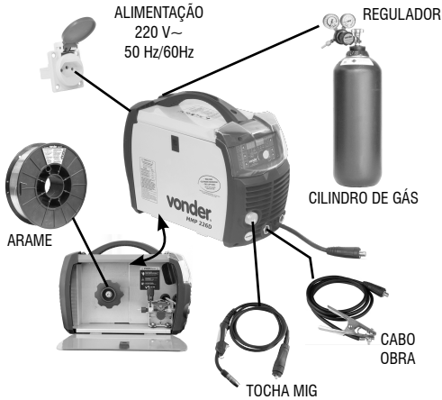
Fig. 2 – Montagem do conjunto
