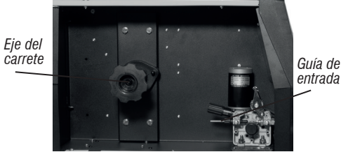
Fig. 5 – Montaje del rodillo de alambre
