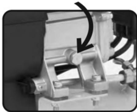
Fig. 6 – Parafuso de drenagem do cárter
