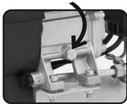
Fig. 6 – Tornillo de drenaje del cárter
