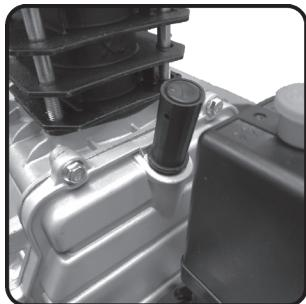
Fig. 4 – tampa de respiro do cárter
