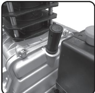
Fig. 4 – Tapa de respiradero del cárter
