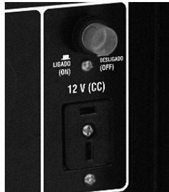
Figura 15 – Disyuntor del circuito CC
