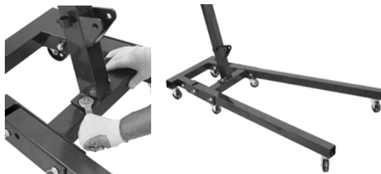
Figura 6 – Fijación de la torre en la estructura inferior de la grúa montada
