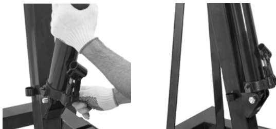
Figura 8 – Fijación del sistema hidráulico en el soporte de la torre
