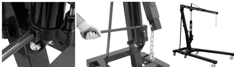
Figura 14 – Acionamento do sistema hidráulico do guincho
