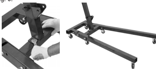
Figura 6 – Fixação da torre na estrutura inferior do guincho montado
