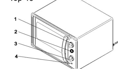
1 **Termostato:** Seletor de temperatura que varia de de 0 ° C até 300 ° C.
